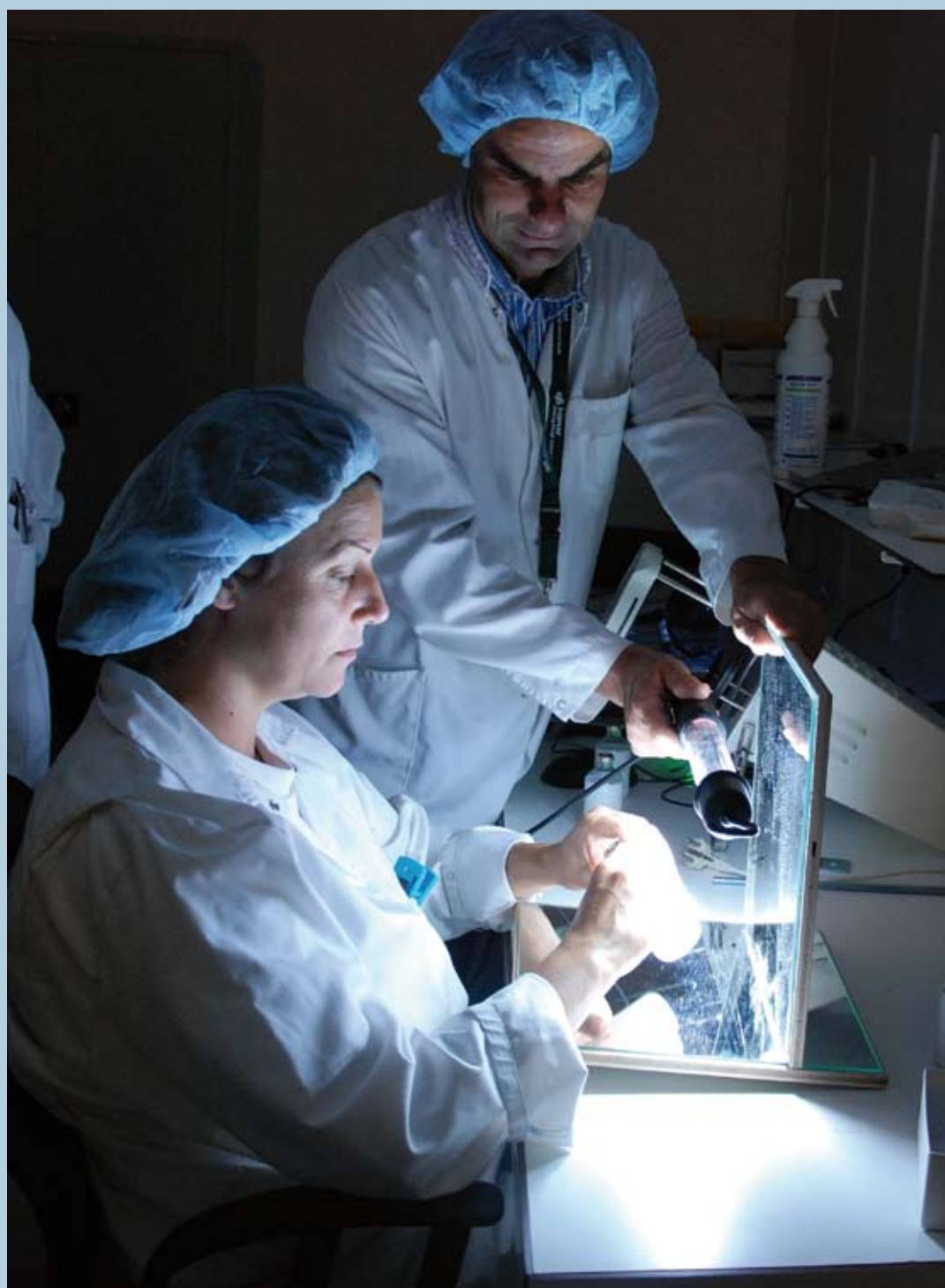
Medewerker test visuele inspectie met spiegelopstelling
